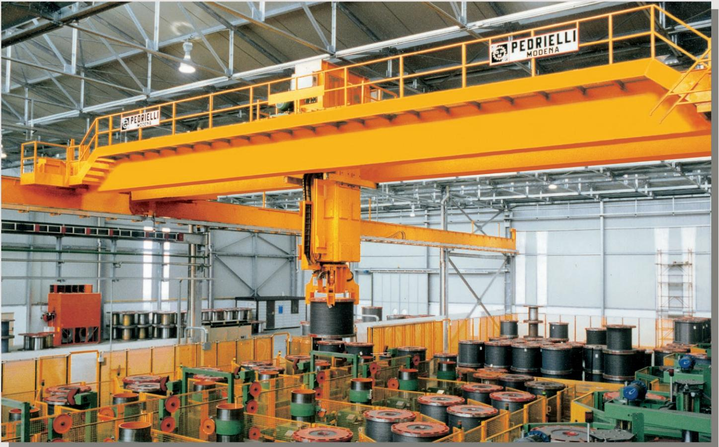
*Gru a ponte in esecuzione bitrave con capacità di carico 10.000 Kg, a completo funzionamento automatico, inserita in un sistema di supervisione aziendale, dotata delle più recenti e avanzate tecnologie elettroniche ed elettromeccaniche. Tale soluzione, a titolo esemplificativo, risponde a tutte le necessità di movimentazione all'interno di uno stabilimento di trafilatura dell'acciaio, garantendo l'esecuzione dell'intero ciclo di produzione senza la necessità di presenza dell'uomo.*
