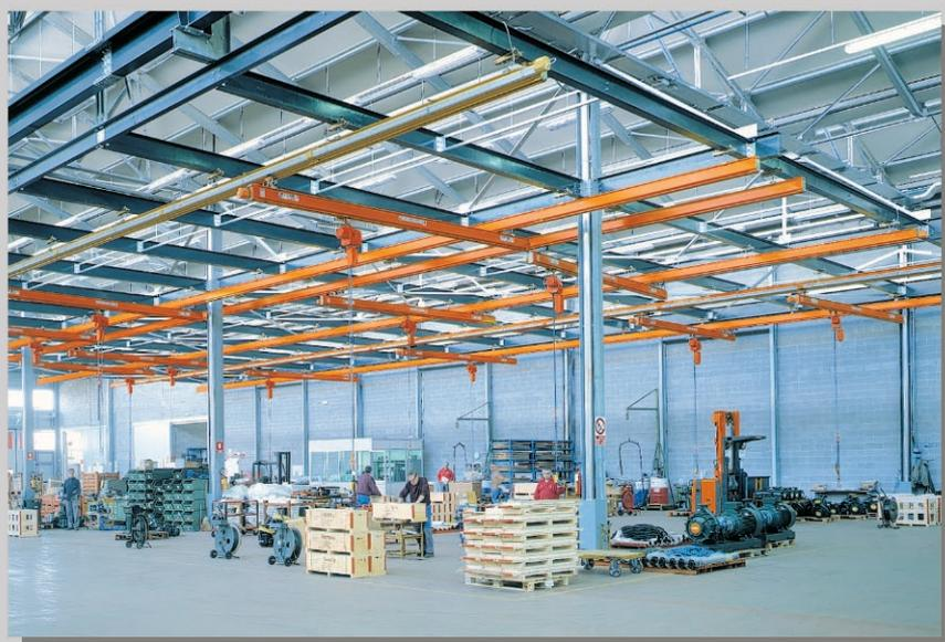
Serie di grù a ponte sospese con struttura di sostegno aerea.
