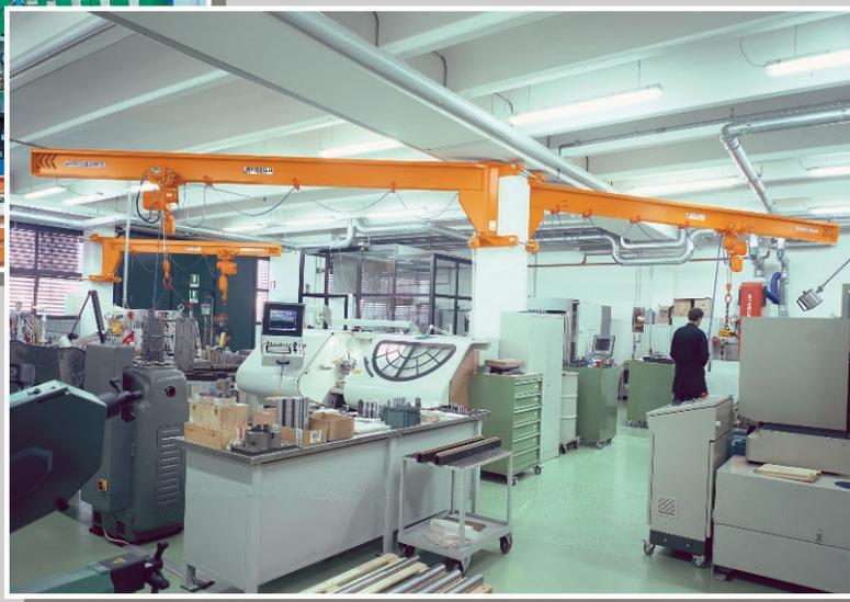
Gru a bandiera speciali integrate a banchi su linee in catena di montaggio, complete di attrezzature sottogancio certificate per la presa e la movimentazioni dei particolari nelle varie fasi del ciclo di lavorazione.
